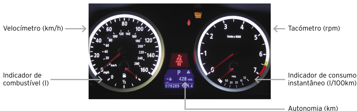
Fig. - Instrumentos principais indicadores do consumo do veículo
